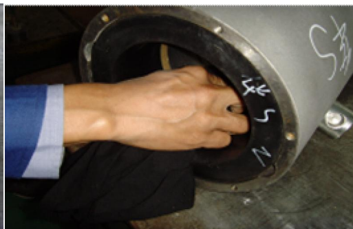
图 6 清理制动器内部
